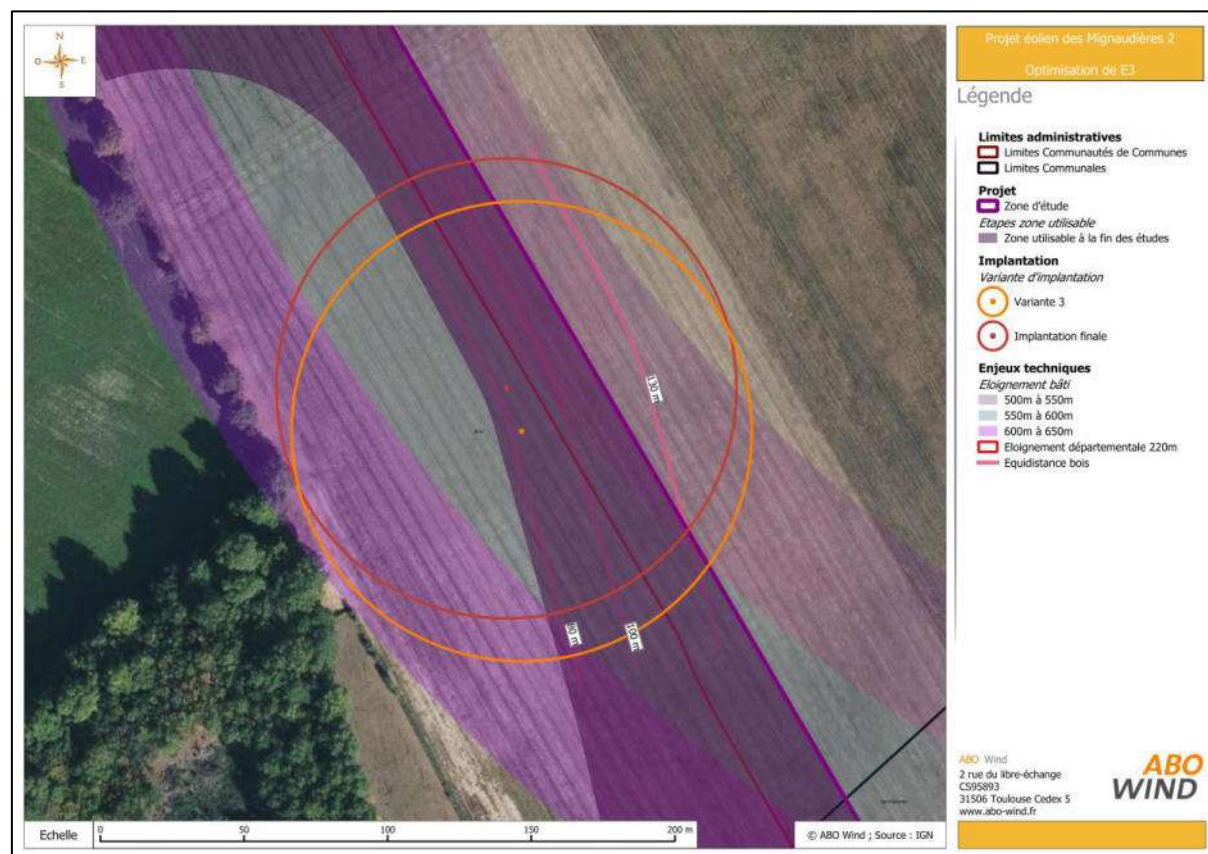
Figure 328 : Optimisation de l'éolienne E3 (Source : ABO Wind)
